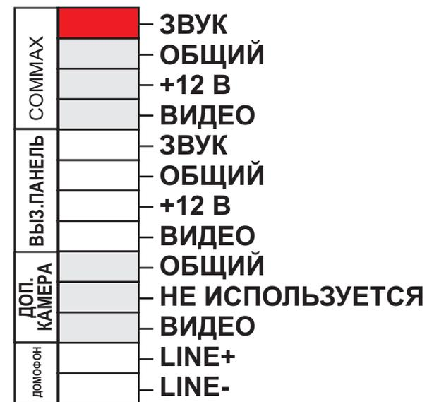
Цоколёвка соединительного разъёма
