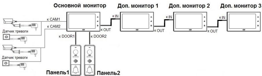
Вызывные панели подключаются только к основному монитору.
